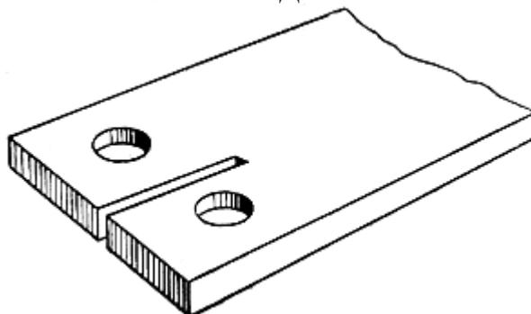
1. Контакт-детали, имеющие два и более отверстия под болты в поперечном ряду, рекомендуется выполнять с продольными разрезами, как показано на чертеже.
