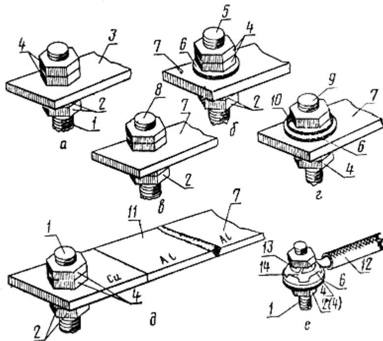
*а* - проводник из меди, твердого алюминиевого сплава или алюминия с защитным металлическим покрытием рабочей поверхности; *б, в, г* - алюминиевый проводник; *д* - алюминиевый проводник через переходную медно-алюминиевую пластину; *е* - однопроволочная (многопроволочная) жила провода кабеля сеч. 10 мм<sup>2</sup> с изгибанием в кольцо
