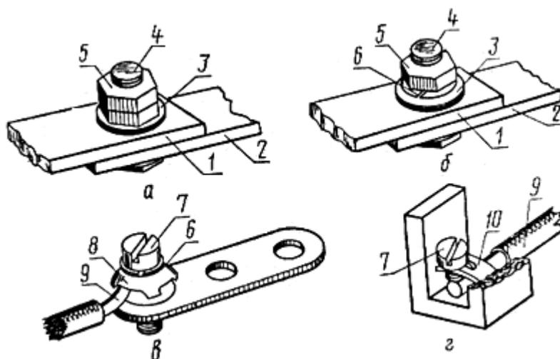
*а* - с контргайкой; *б* - с пружинной шайбой; *в* - однопроволочная (многопроволочная) жила провода (кабеля) сеч. до 10 мм<sup>2</sup> с изгибанием в кольцо; *г* - однопроволочная (многопроволочная) жила провода (кабеля) сеч. до 10 мм<sup>2</sup> без изгибания в кольцо
